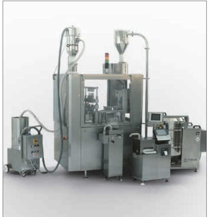
Pneumatischer Transporter (links) und Kapselförderer (rechts) in einem Pharmaunternehmen.
